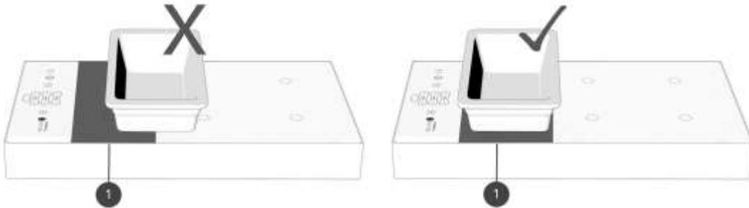
Es ist darauf zu achten, dass die Glasplatte beim Aufsetzen und Abnehmen der Gefässe nicht durch die Gefässkanten verkratzt wird.
