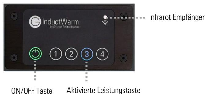
**Mittels Infrarot-Fernbedienung (optional):** Die Leistungsstufe kann optional mit der Infrarot-Fernbedienung eingestellt werden. Dazu muss die Fernbedienung in die Nähe (ca. 20-30cm Abstand) des Infrarot Empfängers der externen Bedieneinheit oder direkt zum Gerät gehalten werden.
