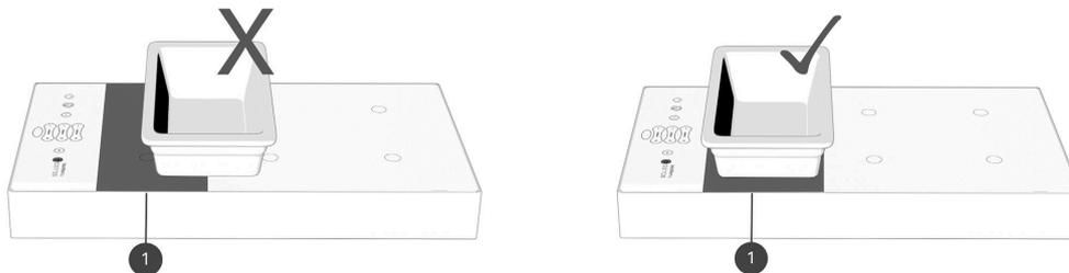
Es ist darauf zu achten, dass die Glasplatte beim Aufsetzen und Abnehmen des Porzellans nicht durch die Kanten der Porzellanfüsse verkratzt wird.
