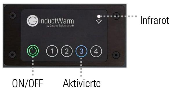
**Mittels Infrarot-Fernbedienung (optional):** Die Leistungsstufe kann optional mit der Infrarot-Fernbedienung eingestellt werden. Dazu muss die Fernbedienung in die Nähe (ca. 20-30cm Abstand) des Infrarot Empfängers der externen Bedieneinheit oder direkt zum Gerät gehalten werden.
