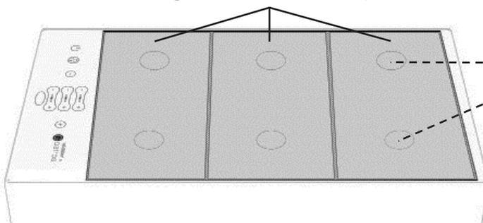
Zwei Induktionsspulen pro Warmhaltezone ermöglichen es, mehrere Gefässe pro Zone zu platzieren.
